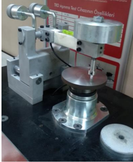
Şekil 2.2 Aşınma deney düzeneği
