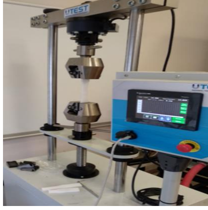
Şekil 2.1 Çekme deneyi düzeneği
