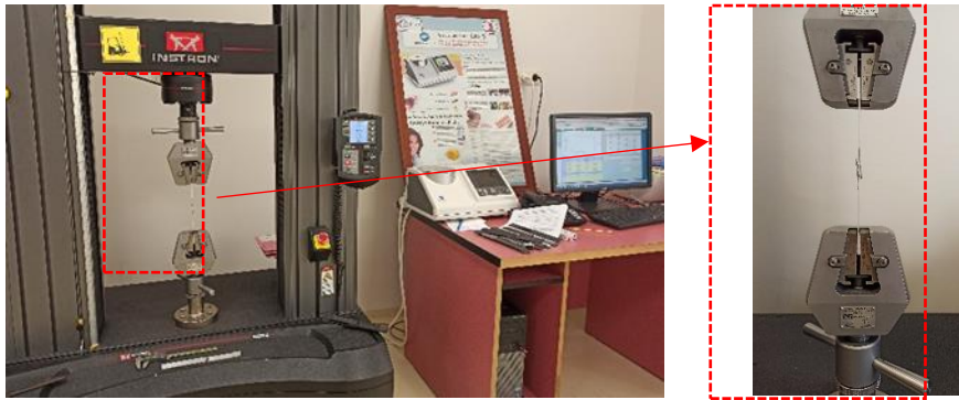
Şekil 6. Bağlantı numunelerinin çekme testi
