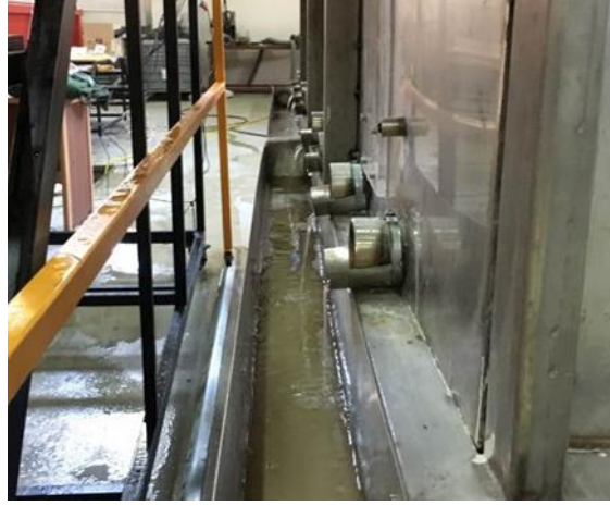
Şekil 5. Deney Sisteminde Suyun Oluklar Yardımıyla Toplanması
