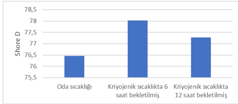
Şekil 3.7 Sertlik deney sonuçları grafiği
