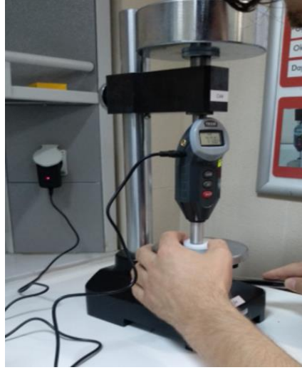
Şekil 2.3 Numunelerin shore d sertlik cihazında ölçülmesi
