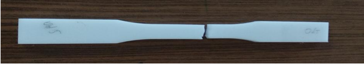
Şekil 3.2 Çekme deneyi sonrası numune
