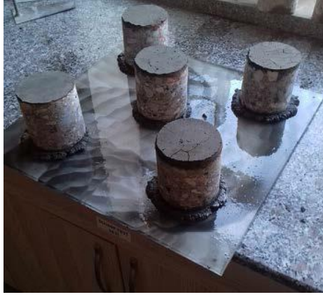
Şekil 2. Çimento başlıklama yapılmış silindirik karot numuneleri
